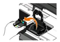
Warnung - Mögliche Schäden: Berühren Sie nicht den Tintenfilter oder die Düsen des Druckkopfs.
