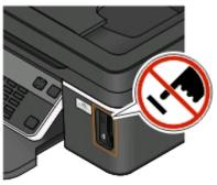
**Warnung - Mögliche Schäden:** Kabel, Netzwerkadapter, Anschlüsse, Speichermedium oder Drucker sollten im angezeigten Bereich während eines Druck-, Lese- oder Schreibvorgangs mittels Speichermedium nicht berührt werden. Daten können verloren gehen.
